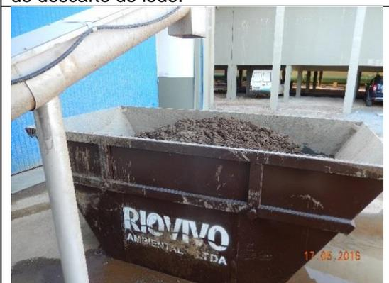
**Foto 1670 – 17/05/16:** Caçamba recebendo lodo da centrífuga proveniente do floco-decantador.
