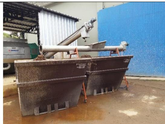
**Foto 155005 – 06/07/16:** Caçamba estacionária com lodo proveniente da centrífuga de lodo.
