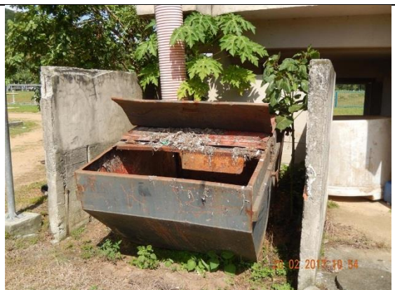
Foto nº 4498 de 20/02/17 - Caçamba estacionária que recebe a areia, sem registro ou torneira para o vazamento do líquido percolado ou a água da chuva.
