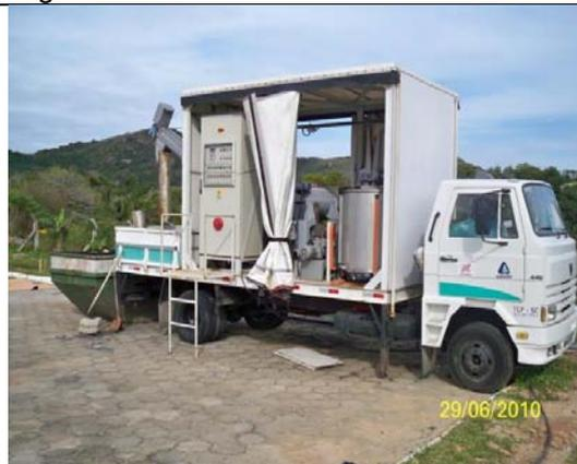
Foto 2785 – caminhão com a centrífuga de desidratação de lodo
