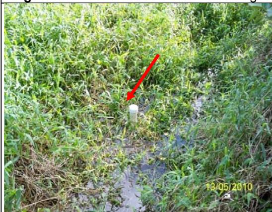
Foto 2461 – Piezômetro 6 localizado em região alagada no entorno da lagoa evapo-infiltração
