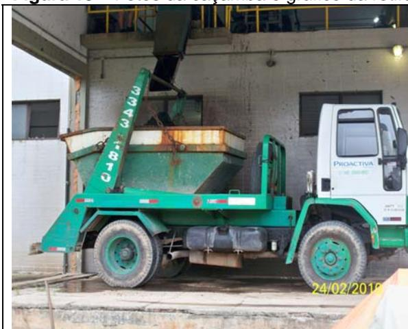
**Foto nº 2311 – 24/02/2010:** Caminhão de transporte de lodo prensado da ETE Insular.
