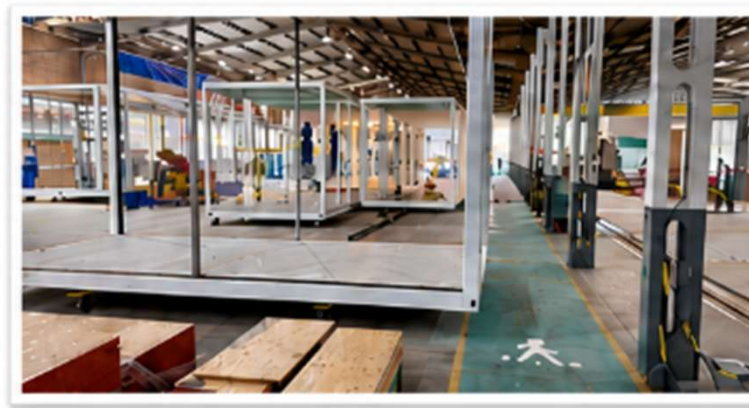
Módulos volumétricos 3D com estrutura em aço, laje em concreto e painéis em concreto reforçado com fibra de vidro.
