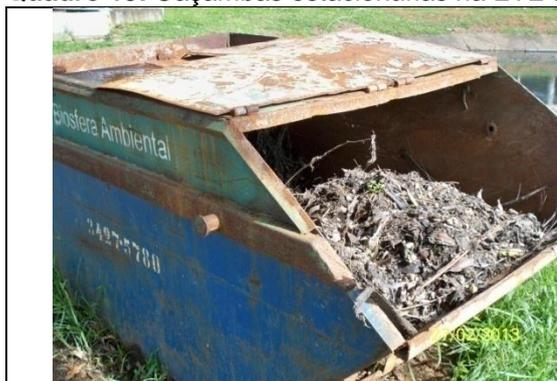
Foto nº 82 – Caçamba com material retirado da caixa de entrada do esgoto na Estação, espuma e sobrenadantes no dia 27/02/13.
