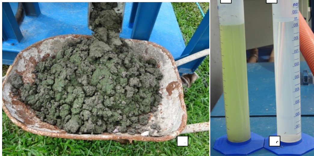
Figura 3: Produto final. e) Lodo centrifugado. f) Comparação entre a água de entrada (1) no processo e a água de saída (2), após separação lodo/água.
