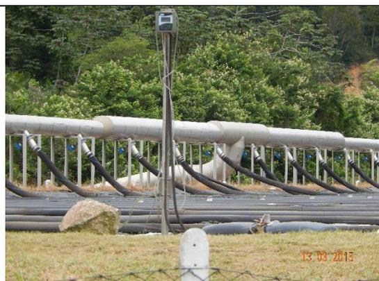
Foto nº 0523 de 13/03/2015 TCE – sonda oxigênio sem calibração.
