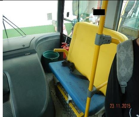
Foto nº 16 - veículo próprio placas MKS 3926 com bancos colocados em cima da roda dianteira.
