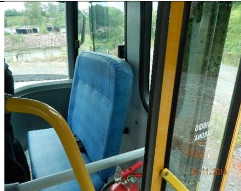
Foto nº 40 - veículo próprio placas MJE 3914 com bancos colocados em cima da roda dianteira.
