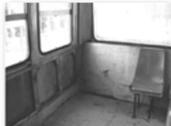
Foto 20 em 24/11/2009 — veículo próprio placa LYM 5661 com falta de bancos e da proteção lateral interna — Cerro Negro
