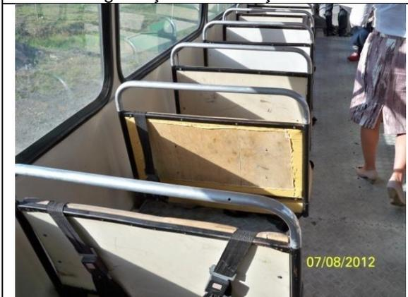
Foto 81 – veículo terceirizado placas L郑 0229 cinto de segurança sem condições de uso
