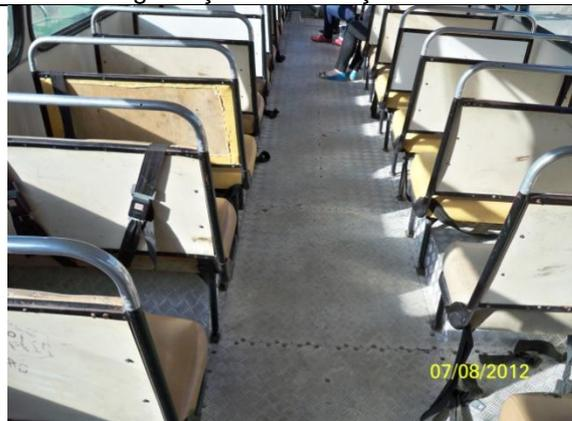
Foto 83 – veículo terceirizado placas L郑 0229 cinto de segurança sem condições de uso
