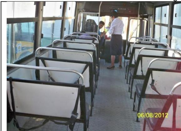
Foto 08 – veículo terceirizado placas KBC 7700 cinto de segurança sem condições de uso
