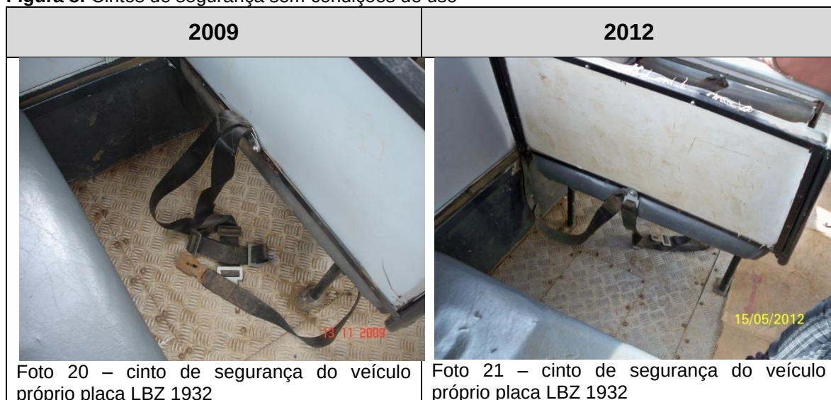
Figura 8: Cintos de segurança sem condições de uso
