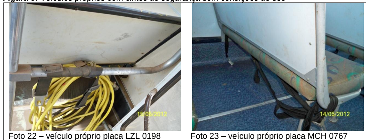
Figura 9: Veículos próprios com cintos de segurança sem condições de uso
