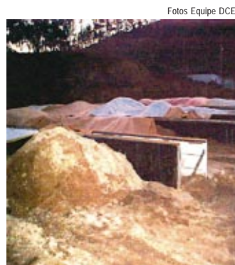
Avanço 1: armazenamento e tratamento apropriado do material grosseiro e do lodo desidratado (torta)
