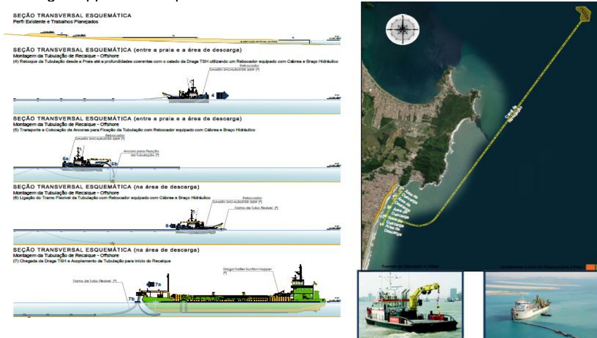
Figura 5 – Imagem extraída do projeto de alimentação artificial da Praia do Gravatá, que ilustra o procedimento de montagem da tubulação de recalque e do acoplamento da draga hopper à linha para o bombeamento dos sedimentos
