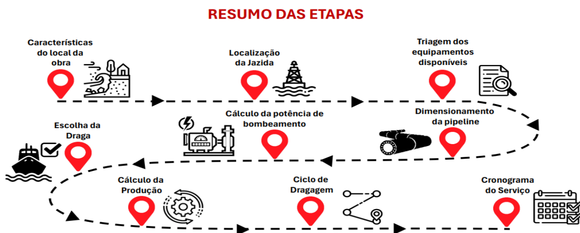
Figura 2 – Representação esquemática das principais etapas do planejamento e do dimensionamento de um projeto de alimentação artificial de praia
