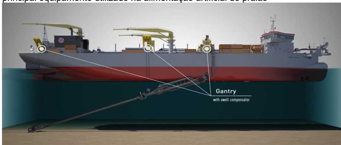
Figura 3 – Representação esquemática de uma draga autotransportadora TSHD, principal equipamento utilizado na alimentação artificial de praias 8
