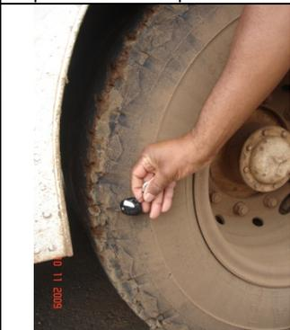
Foto 26 em 10/11/2009 – veículo terceirizado placa LZQ 2325 – pneu dianteiro recauchutado
