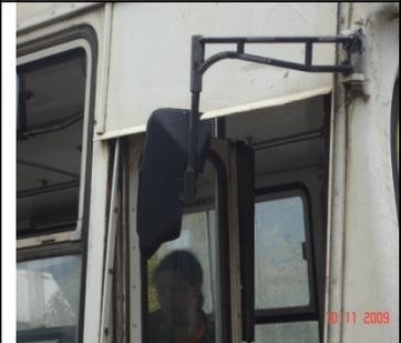
Foto 23 em 10/11/2009 – veículo terceirizado placa LYE 3672 – espelho retrovisor quebrado
