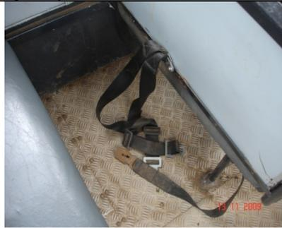
Foto 19 em 13/11/2009 – veículo próprio placa LBZ 1932 – cintos enferrujados e sem condições de uso
