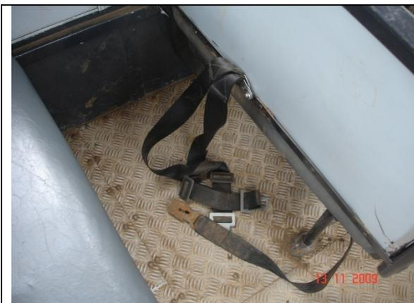
Foto 08 em 13/11/2009 – cinto de segurança do veículo próprio placa LBZ 1932 sem condições de uso
