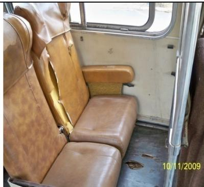
Foto 25 em 10/11/2009 – veículo terceirizado placa LZQ 2325 – banco rasgado e buraco no chão
