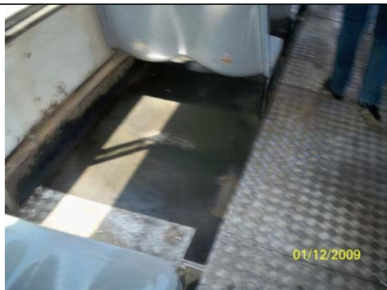
Foto 24 em 01/12/2009 – falta de bancos.
