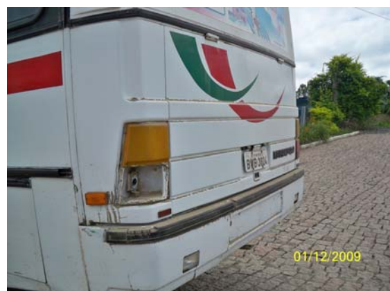
Foto 17 em 01/12/2009 – sinaleira quebrada.
